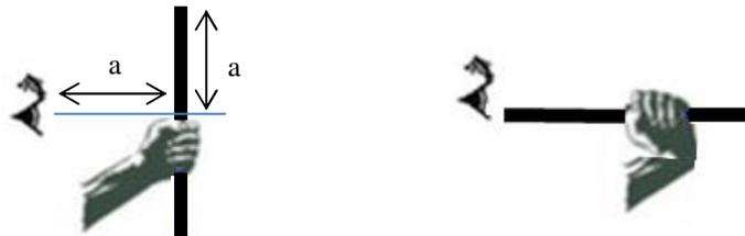
Nun entfernt man sich vom Baum und schaut über den ausgestreckten Arm an dessen Wurzeln, bis der oberste Teil des Baumes hinter dem oberen Stockende verschwunden ist. Nun misst man von diesem Standpunkt die Distanz bis zum Baum (Schrittmass). Die gemessene Distanz ist identisch mit der Baumhöhe.
